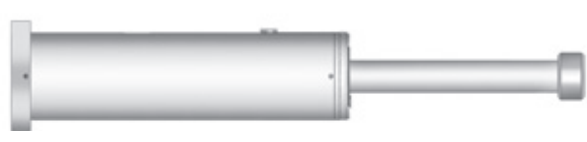
FR:后法兰安装 注:缓冲行程大于300mm时,不宜使用后法兰安装。
